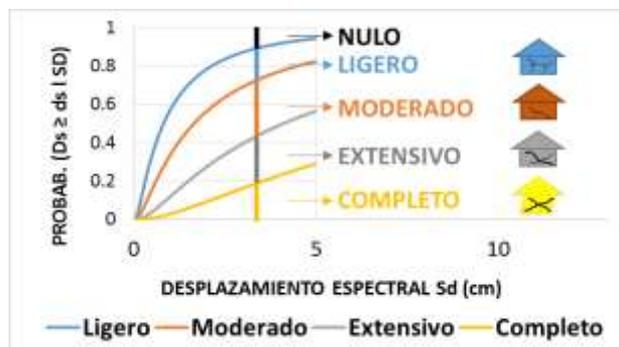
Figura 2.17: Ejemplo de curvas de fragilidad, en donde se representan los estados de daño para diferentes desplazamientos espectrales.
