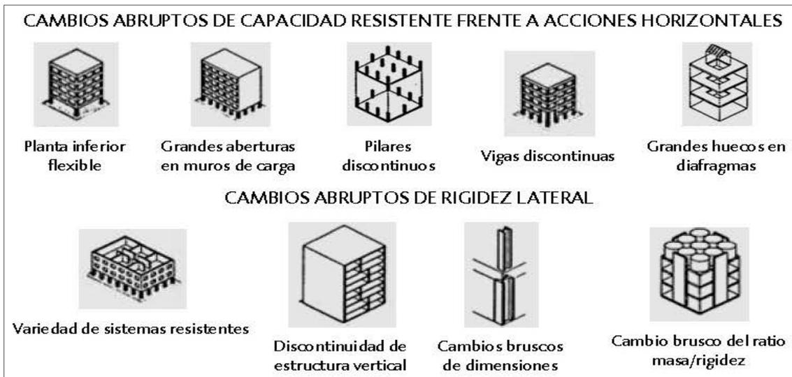
*Figura 2.16 Falta de continuidad en la estructura vertical y cambios de rigidez (guía para la definición de una estrategia antisísmica en el proyecto de edificios de nueva planta, 2012)*
