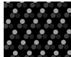
Figura 5.43 Las triadas de Verde-Rojo y Azul son las que crean todos los colores que se observan en las pantallas de televisores y monitores informáticos. Es una buena experiencia acercarse al televisor cuando esté la carta de ajuste y analizar la composición de cada uno de los colores de la pantalla.
