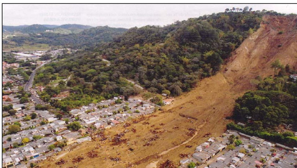
Figura 10.3. Deslizamiento producido por el sismo del 13 de enero de 2001 en la zona de Las Colinas de Santa Tecla, con casi 600 víctimas mortales. El sismo de magnitud M_w 7,7, con epicentro localizado en la costa Oeste de El Salvador, en la zona de subducción entre las placas de Cocos y Caribe, desencadenó más de 600 deslizamientos de ladera (Benito et al., 2004).
